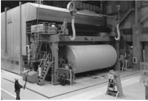
抄紙工程の最終段階で巻き取られたロール状の板紙
