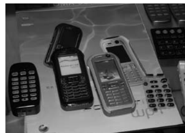
硬質樹脂と軟質樹脂の一体成型によって実現した防水型携帯電話
