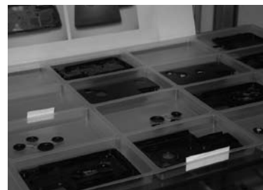
硬質樹脂と軟質樹脂の一体成型を応用した自動車のカードキー
