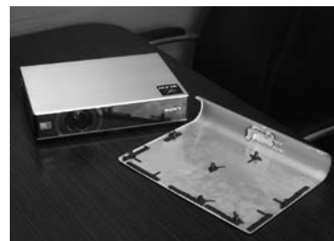
プロジェクターのアルミカバーと一体成型されたプラスチックの突起
