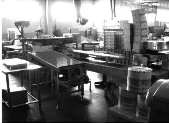
エクレアは1個ずつ包装してから箱詰めする。包装機で個包装したとき自動的に日付が印字されるが、箱詰工程で印字不良を発見すると包装機担当者に声をかけて機械を停止させる。だが、包装機から箱詰工程までは15メートル離れていて、すぐに包装機を停止してもそれまで10～20秒流れた商品が全部ダメになってしまう。そこで使っていないラインを撤去してスペースをつくり、箱詰工程を包装工程から1～2メートルのところ近くに近づけ、印字不良を見つけたときのオシャカを最少限に押さえた。同時にそれまでは不自然な姿勢で長く手を伸ばさねばならなかったが、コンベア台を改良することで立ち位置を変更して作業性をよくし、包装工程の2人を1人に削減した。
